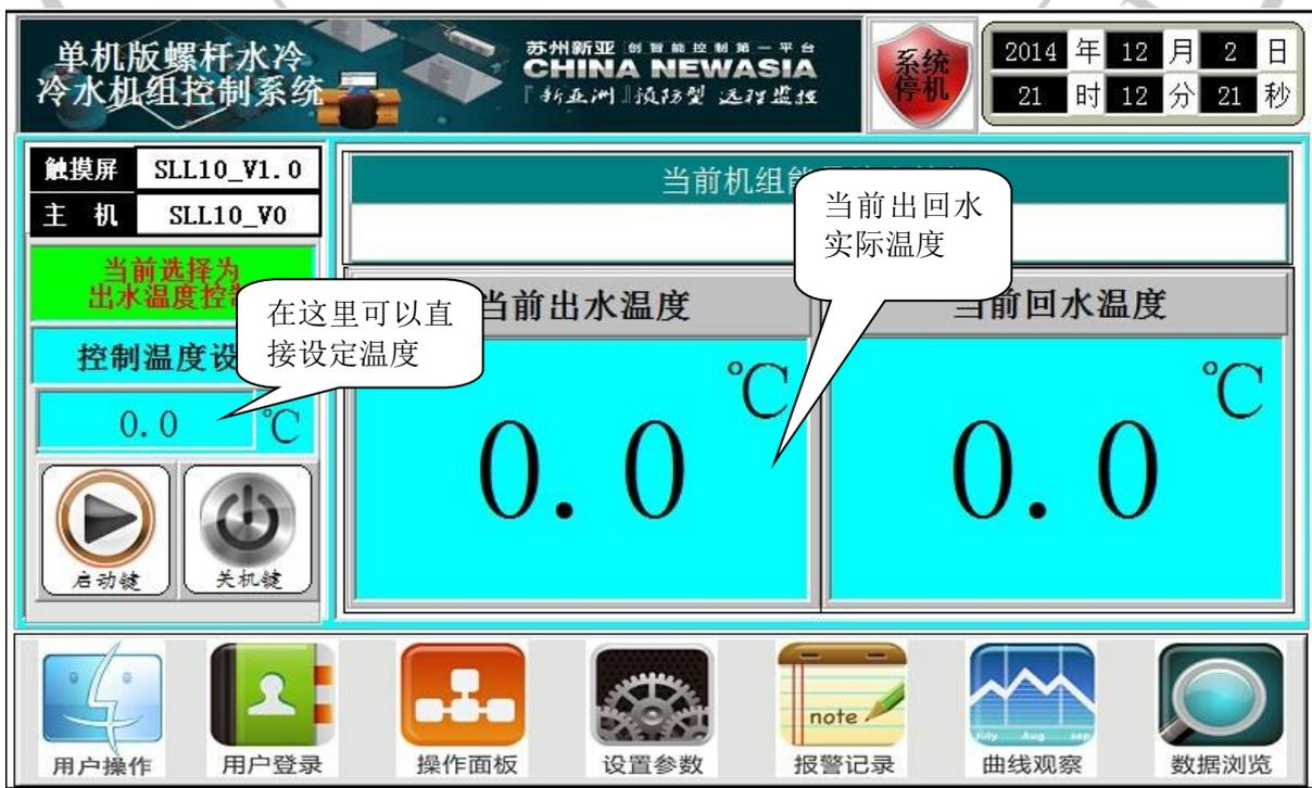
点击《启动键》启动系统，系统正常时显示《系统运行》
