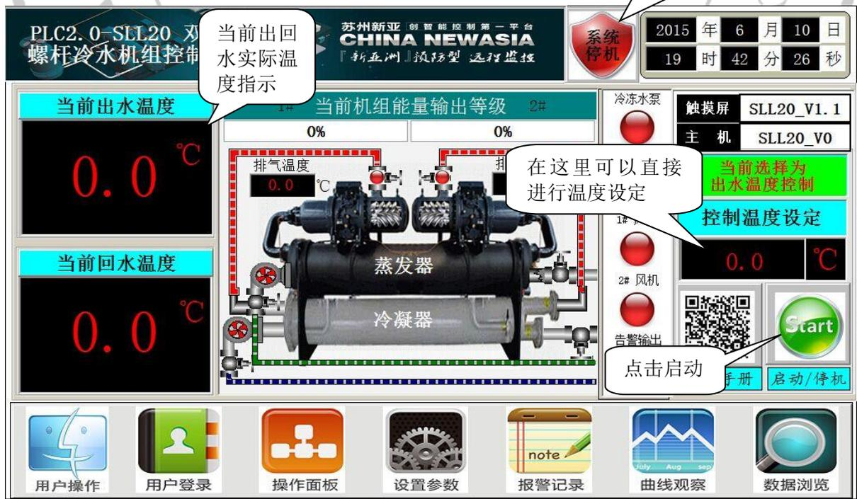
点击《Start 启动键》开机，可能需要三秒左右的延时确认，请稍等确认开机状态。
